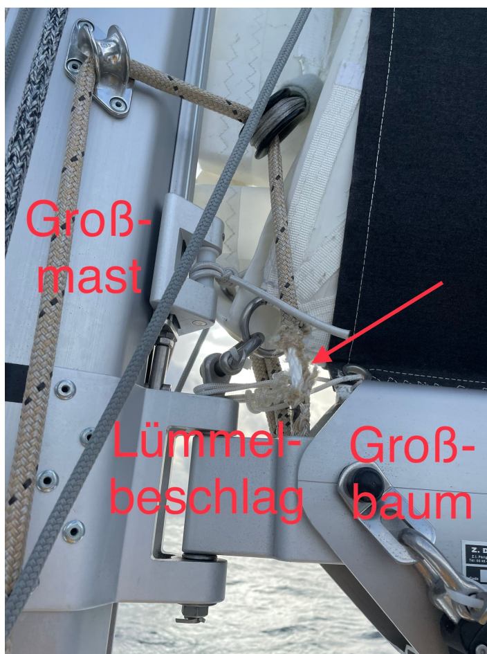
Die Reffleine des ersten Reffs ist angerissen und daher nicht mehr brauchbar. Das Bild zeigt den Großbaum, der über den sogenannten Lümmelbeschlag am Großmast festgemacht ist.
